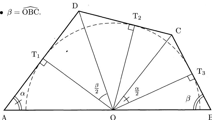
Si A, B, C et D sont cocycliques alors  $\widehat{T_2OT_3} = \pi - \widehat{T_2CT_3} = \widehat{BAD} = \alpha$ , d'où  $\widehat{COT_3} = \alpha/2$ . De même nous avons  $\widehat{DOT_1} = \beta/2$ . Ainsi nous pouvons calculer directement, en utilisant la formule de trigonométrie  $(1/\tan \theta) + \tan(\theta/2) = 1/\sin \theta$ ,
