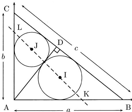
Les triangles ABD et ABC sont semblables, donc  $BD/a = a/c$ , d'où  $BD = a^2/c$ . De même  $CD = b^2/c$  et  $AD = ab/c$ . On peut aussi facilement calculer les coordonnées de D (en remarquant que  $x_D/AD = b/c$  et  $y_D/AD = a/c$ ),
